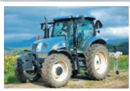
GPSを導入したトラクター。 GPSにより肥料の散布時間は半分に削減。
